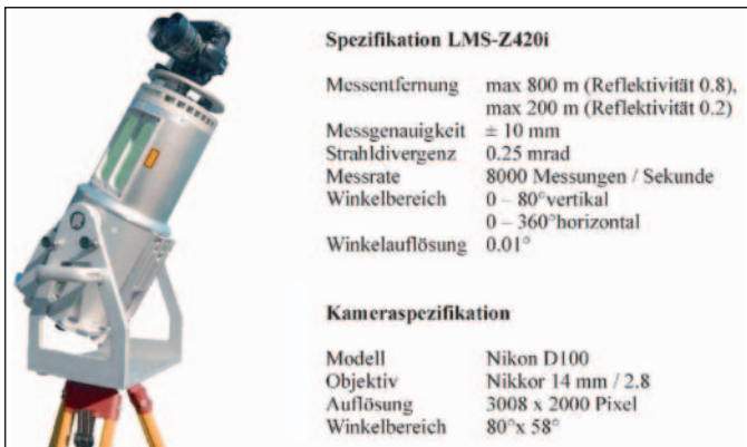
Abb. 2: 3D-Farblaserscanner der Fa. Rieg
