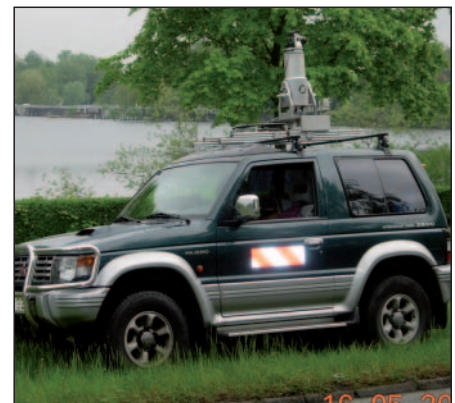
Abb. 3: Vermessung eines Bahnübergangs mit dem Scanner auf dem Autodach
