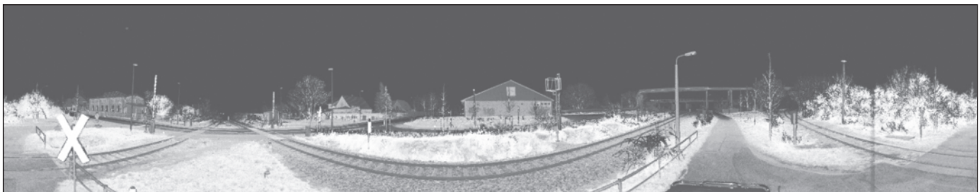
Abb. 4: 360°-Panoramascan – Darstellung der gemessenen Punkte als 3D-Modell nach Intensitätswerten (2 Mio. gemessene Punkte, bei Entfernungen zu der Topographie von bis zu 30 m vollkommen ausreichend)
