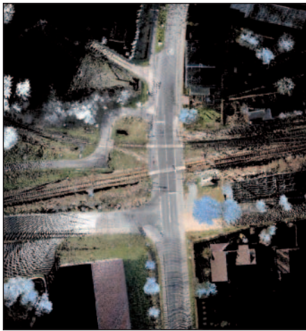
Abb. 6: Eingefärbte 3D-Punktwolke (insg. 8 Millionen gemessene Punkte)
