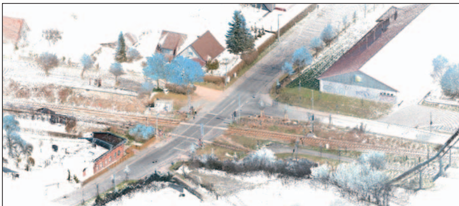
Abb. 9: Ansicht des Bereiches, erfasst mittels 3D-Farblaserscanning
